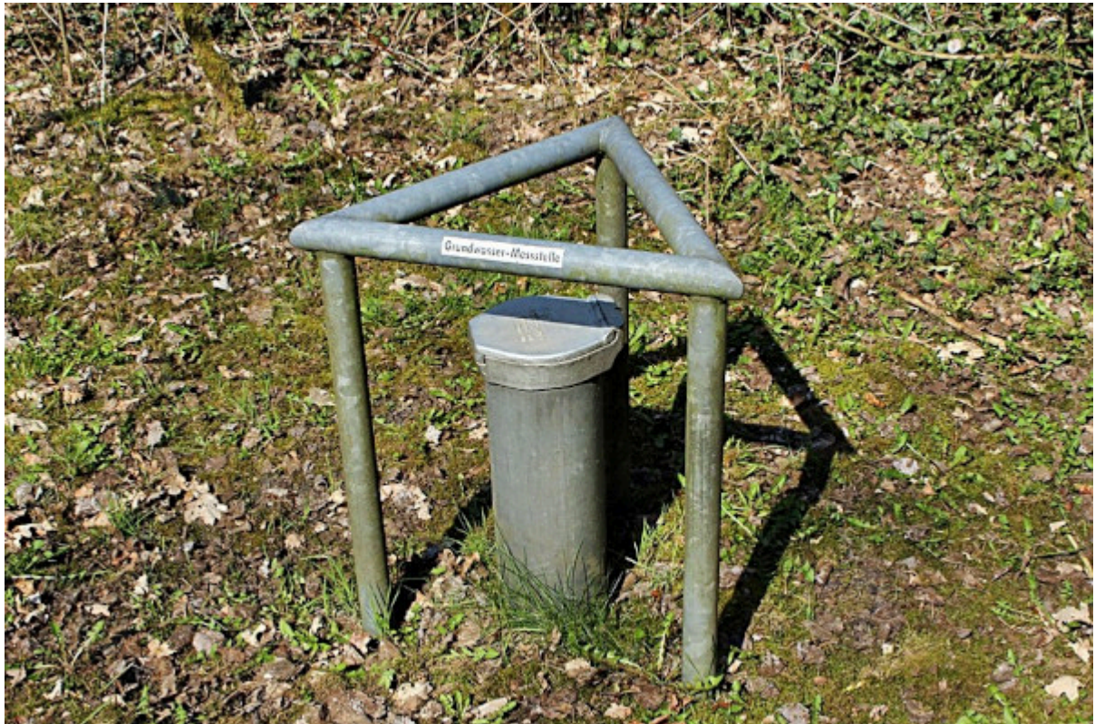
Ein Netz von solchen Grundwasser-Messstellen überwacht die Güte des Rohwassers, aus dem unser
