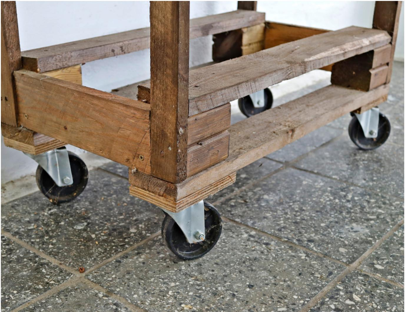
*Die Unterkonstruktion ist fast schon übertrieben stabil angelegt und kann noch einen Boden für eine „untere Etage“ als Ablage oder für ein „tiefer gelegtes Hochbeet“ (Blumenkasten) aufnehmen. Die für 1 m Höhe recht schlanken Dachlattenbeine sind gegen die Distanzklötze des Palettenelements geschraubt und stehen auf einem tragenden Basisbrett.*
