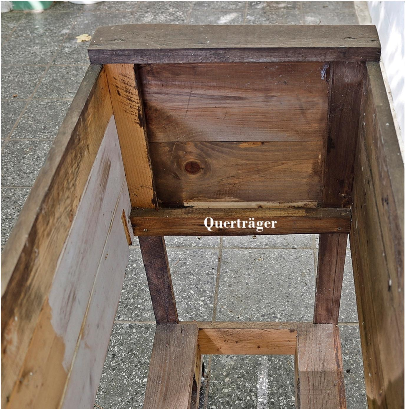
*Blick ins Innere: Außer den beiden Querträgern vor Kopf sollte an den Längsseiten eine weitere Auflage (nicht im Bild) angebracht werden, damit sich der Boden für die Mörtelwanne unter deren Gewicht nicht durchbiegt.*
